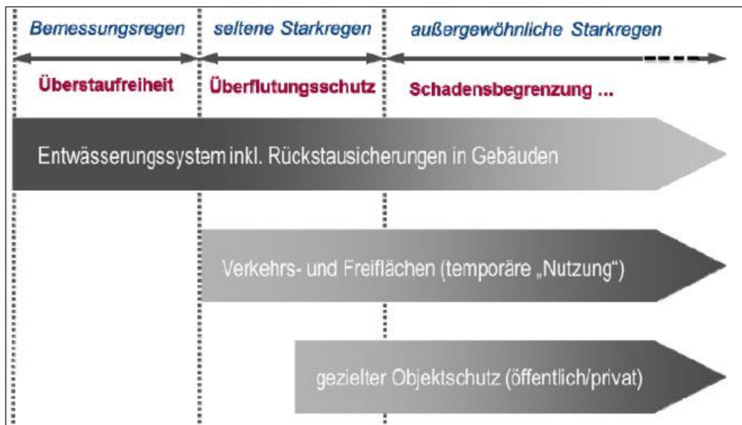
Abbildung 2: Überflutungsschutz und Starkregenrisikovorsorge, DWA M119 [9]
